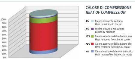
La maggior parte dell'energia utilizzata per produrre aria compressa viene convertita in calore: fino al 90% di questa energia è riutilizzabile! Circa il 75% dell'energia utilizzata nel processo di compressione, si trova nell'impianto di lubrificazione e nel circuito di raffreddamento e può essere riutilizzata come fonte di calore, il restante 15% è contenuta nell'aria compressa.
