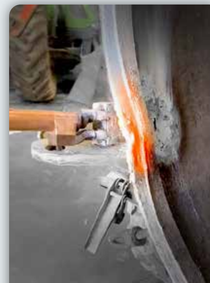
STRAIGHTENING MANURE TANK - REDRESSAGE CUVE À FUMIER Large L20/B4 Powerduction 110LG
