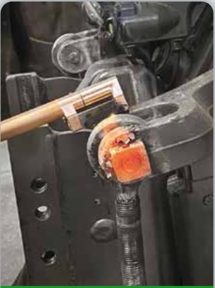
UNSEIZING LINKAGE ARMS - DÉGRIPPAGE BRAS DE RELEVAGE Large L90 Powerduction 160LG
