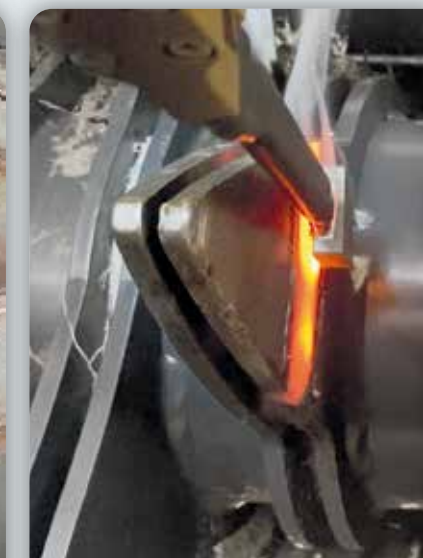
ROUND BALERS ROTOR TEETH STRAIGHTENING - REDRESSAGE DE DENTS DE ROTOR DE PRESSE À BALLES RONDES Large L-X1/B1 Powerduction 220LG
