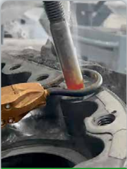
RELEASING ENGINE STUDS - DÉGRIPPAGE DE GOUJON DE CARTER Small S180/D30 Powerduction 37LG
