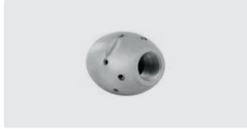
1/4" F. 6x 75° 3x 30° + 1x 0°. 25-70 l/min. For (R) (D) 75-150 mm. Outside (D) 30 mm. (S) 223 g.
