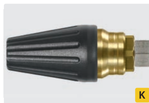
M18 F. Spray angle 20°. 200 - 400 bar. Max. 100 °C
