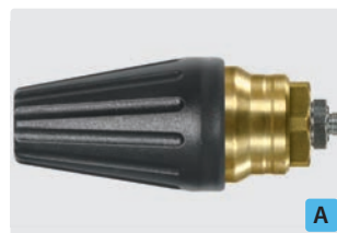
1/8" M. Spray angle 20°. 200 - 400 bar. Max. 100 °C
