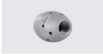
3/8" F. 6x 75° 3x 30° + 1x 0°. 30-100 l/min. For (R) (D) 100-200 mm. Outside (D) 35 mm. (S) 314 g.
