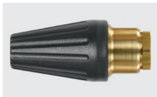
1/4" F. Spray angle 20°. 120 - 250 bar. Max. 100 °C
