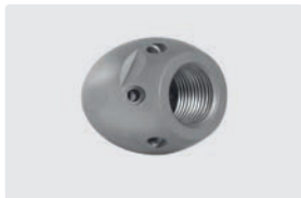
3/8" F. 6x 75° + 1x 0°. 25-70 l/min. For (R) (D) 75-150 mm. Outside (D) 35 mm. (S) 207 g.
