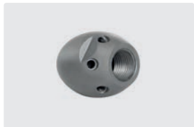
1/4" F. 6x 75° + 1x 0°. 20-50 l/min. For (R) (D) 50-100 mm. Outside (D) 30 mm. (S) 127 g.
