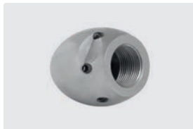
1/2" F. 6x 75° + 1x 0°. 30-100 l/min. For (R) (D) 100-200 mm. Outside (D) 40 mm. (S) 281 g.
