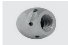
3/4" F. 6x 75° + 1x 0°. 30-100 l/min. For (R) (D) 120-250 mm. Outside (D) 50 mm. (S) 567 g.
