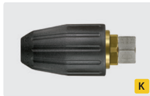
M18 F. Spray angle 20°. 200 - 350 bar. Max. 100 °C
