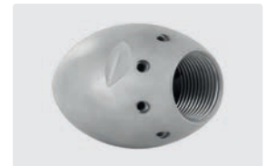
1" F. 8x 75° + 1x 0°. 100-250 l/min. For (R) (D) 150-300 mm. Outside (D) 62 mm. (S) 1,265 g.
