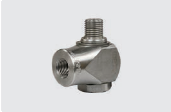
1/4" F : 1/4" M. Max. 400 bar / 30 r.p.m. / 90 °C
