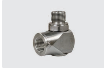
3/8" F : 3/8" M. Max. 400 bar / 30 r.p.m. / 90 °C
