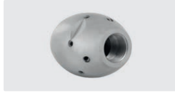
1/2" F. 6x 75° 3x 30° + 1x 0°. 80-140 l/min. For (R) (D) 120-250 mm. Outside (D) 40 mm. (S) 630 g.
