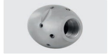
3/4" F. 6x 75° 3x 30° + 1x 0°. 100-250 l/min. For (R) (D) 150-300 mm. Outside (D) 50 mm. (S) 1,367 g.
