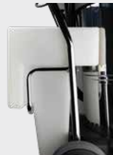
Detergent tank / Serbatoio detergente
