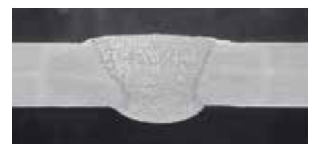
Head to head 4 mm aluminium welding. Excellent weld pool penetration and stability. Saldatura alluminio testa a testa 4mm. Ottima penetrazione e stabilità del bagno.
